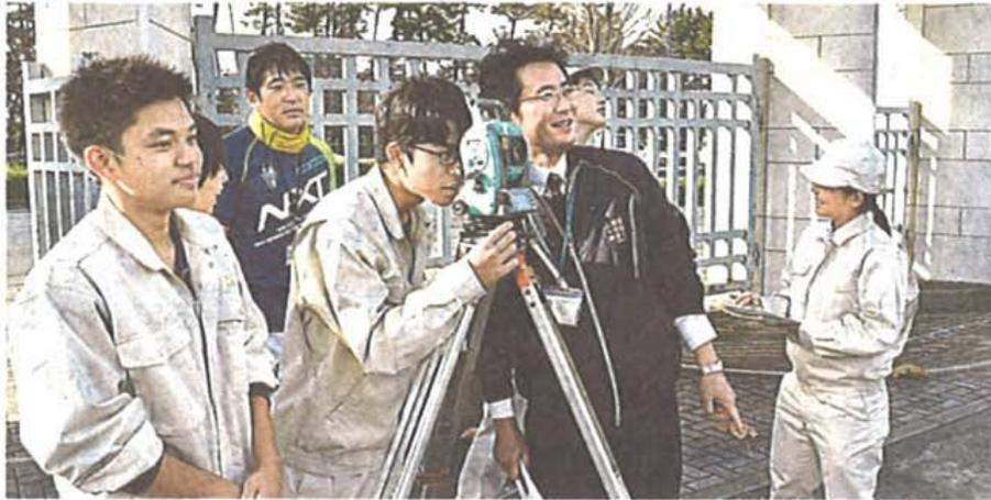
距離と角度で土地面積を測る機器「トータルステーション」の操作に挑戦した＝写真＝。衛星利用測位システム(GPS)の受信機を使って校庭から埋設物を見つけ出す作業にも取り組んだ。
